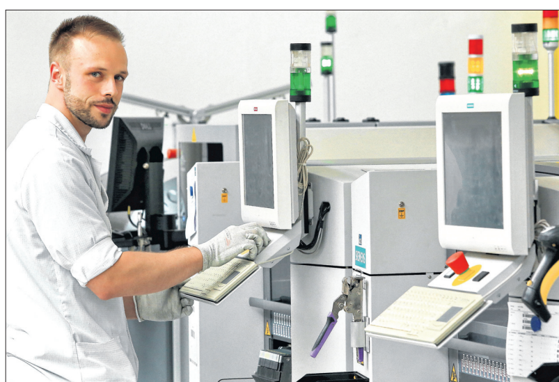
Konstruktionsmechaniker Richard Kurth (29) kontrolliert die Computeranzeige einer vollautomatischen Bestückungsline. Fotos: Dietmar Lilienthal
